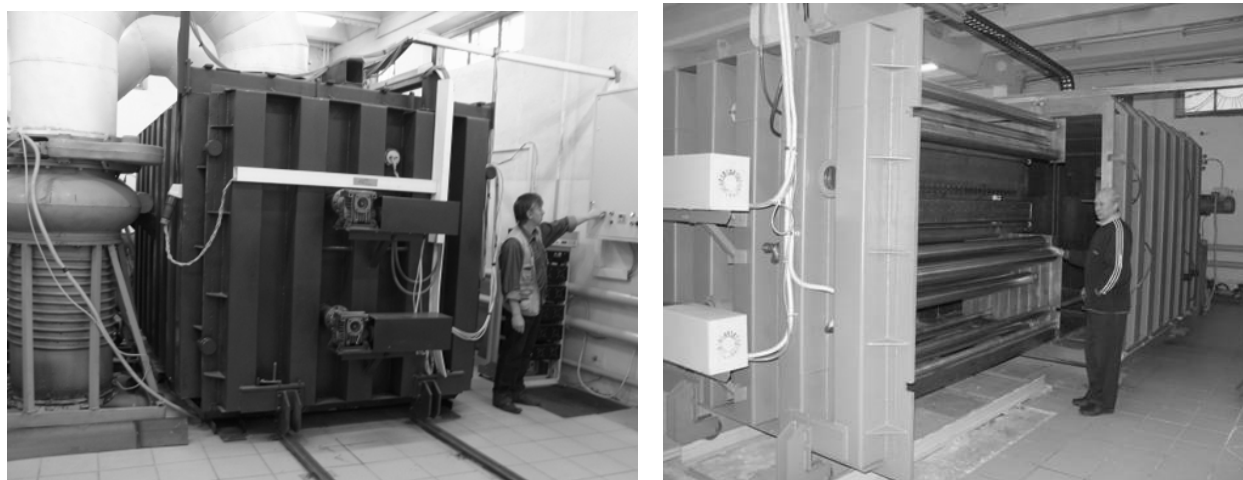
Рис. 2. Фотографии установок УМН-180 и ММ-180 для нанесения покрытий на ткани и полимерные пленочные материалы
