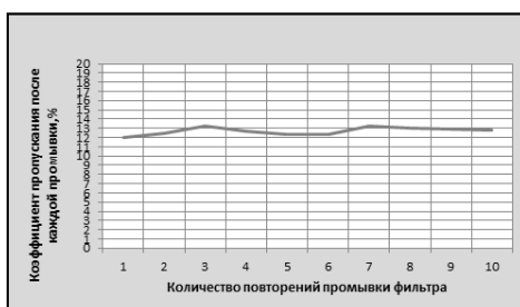
Рис. 8 Зависимость коэффициента пропускания от количества промывок
