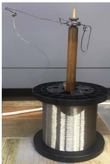
Рис.2. смотка металлической нити с катушки с помощью бегунка
