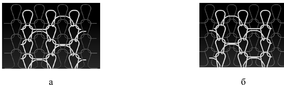
Рис.3 – 3D модель двухслойного трикотажа: а – прессовая сторона; б – непрессовая сторона
