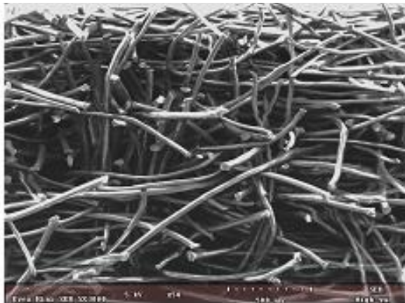
«Геоком Д», иглопробивное, каландрированное с одной стороны, 393 г/м 2 . Штапельное волокно: полиэфирные - 20 %; полипропиленовые - 80 %. ООО «Комитекс».
