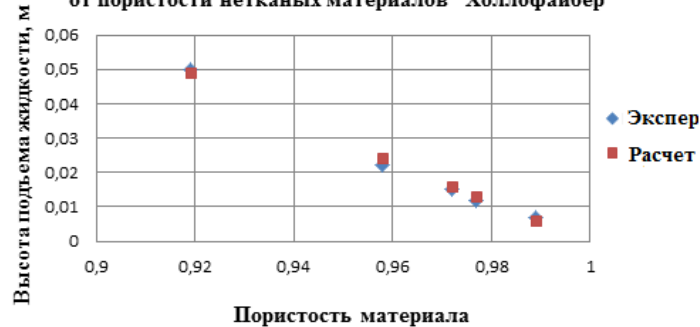
Сопоставление экспериментальных и расчетных значений высоты подъема жидкости в зависимости от пористости нетканых материалов "Холлофайбер"
