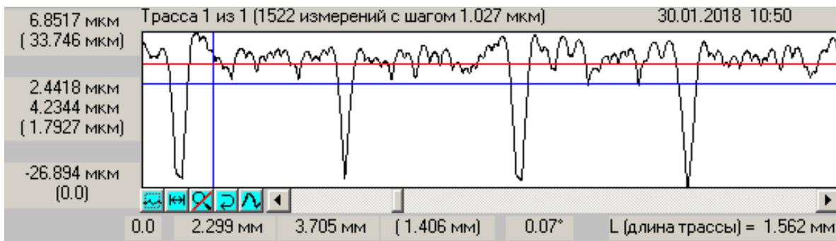
Рис.1. Профилограмма поверхности ПЭТФ – пленки
