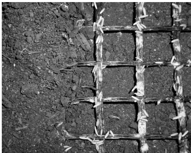
Рис.3. Опытный образец георешетки, уложенной в грунт
