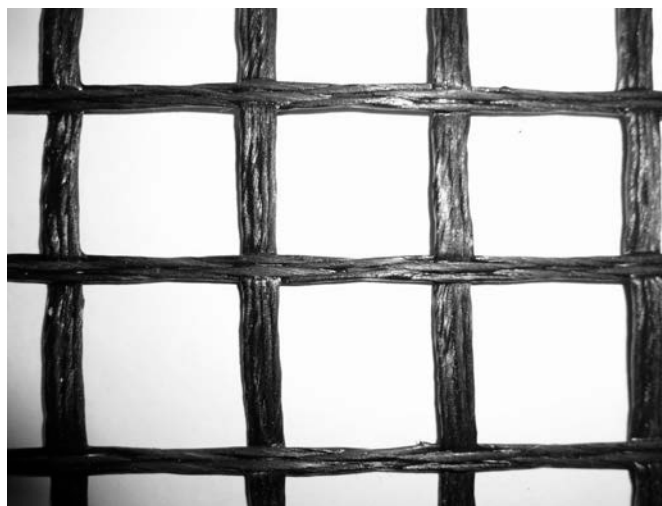
Рис.1. Фрагмент георешетки, изготовленной ООО «Ультрастаб»
