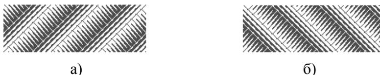
Рис. 3. Раппорты наклонных теневых переплетений, полученных на базе саржи 1/5: а) с наклоном полос вправо; б) с наклоном полос влево
