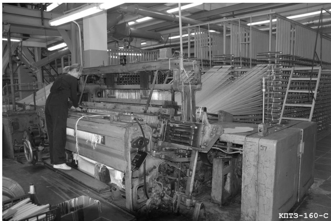
Рис. 6. Фотография ткацкого станка для изготовления многослойных тканей сложных структур
